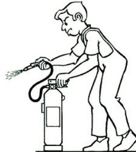
3. Esto permitirá accionar la válvula para producir la descarga del agente extintor.
